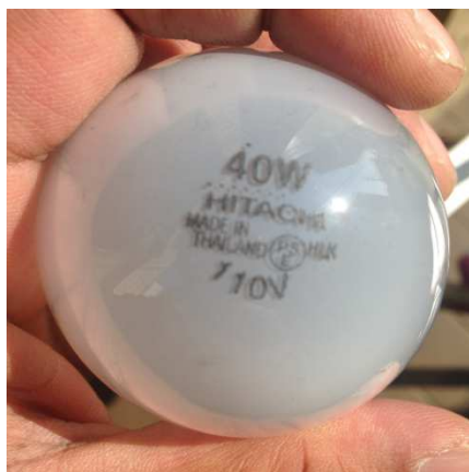
外壁灯 40W白熱電球から電球型7W LED灯への換装
