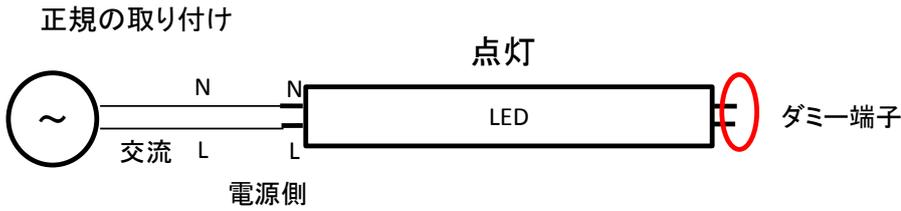
反対に取り付け 給電側にダミー端子がくるので 電気は流れず点灯しない。事故は発生しない。
