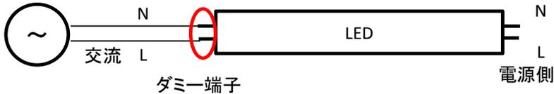
④-2. 片側給電の器具に両側給電のLED管を差す。
